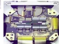
FPAs: PV HgCdTe to 13.7  $\mu\text{m}$ , PC HgCdTe to 15.4  $\mu\text{m}$
